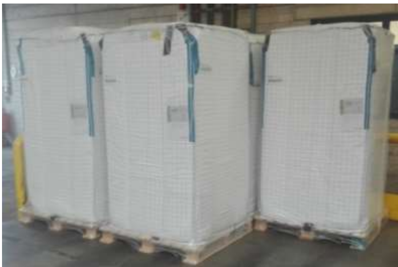
Ladeeinheitenbildung durch Schrumpfhauben über FIBC
