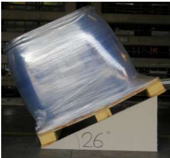
Palettierte Fassware im 26° Kipptest (mit Hilfsschablone)
