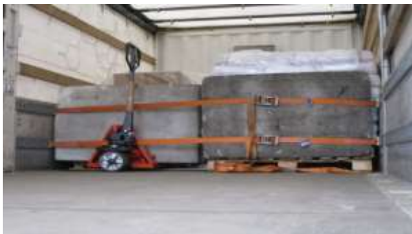
Sicherung des Handhubwagens in Ladungssicherung integriert
