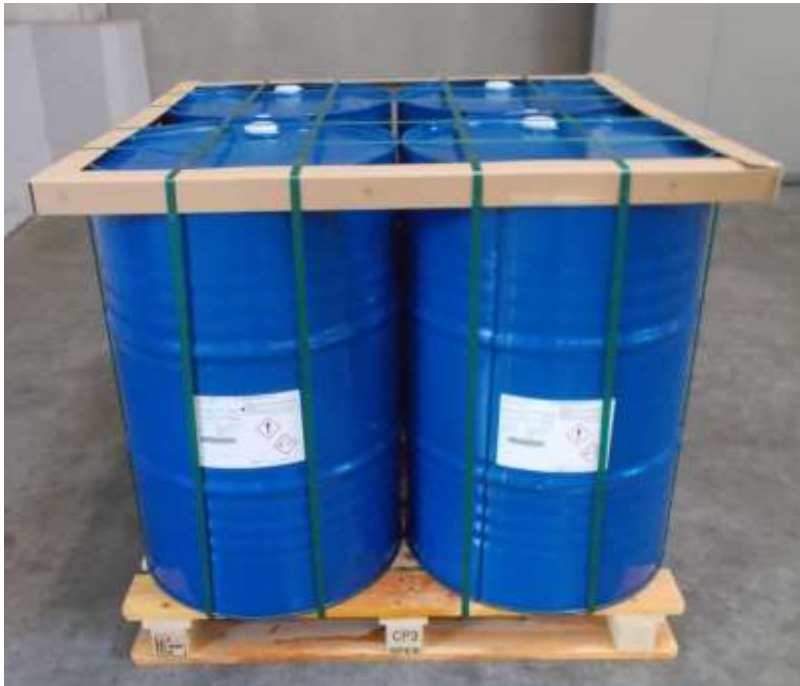
Ladeeinheitenbildung durch vertikale Bänderung von Stahlfässern
